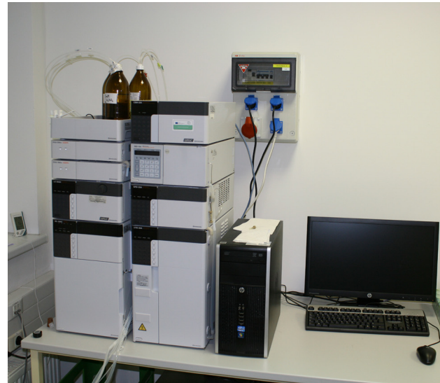
Kapalinový chromatograf Shimadzu řady LC20 s autosamplérem, UV-Vis a refraktometrickým detektorem
